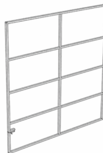
Ossature du vantail
